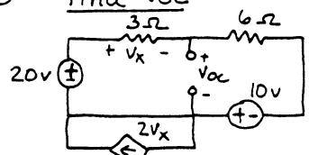
$$\text{KVL left mesh } \uparrow : -20 + V_x + V_{oc} = 0 \quad (1)$$
