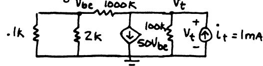
$$\text{KCL at } V_{be} : \frac{V_{be}}{1k} + \frac{V_{be}}{2k} + \frac{(V_{be} - V_t)}{1000} = 0$$
