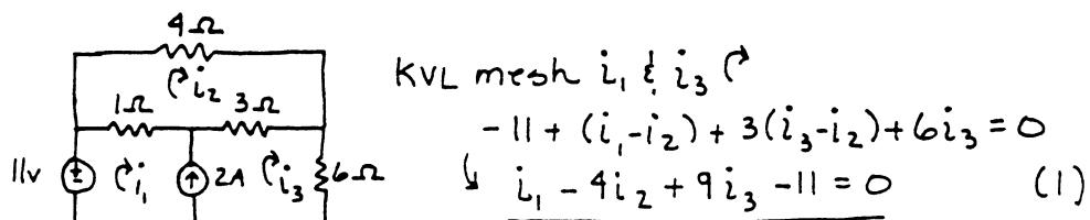
$$\text{KVL mesh } i_2 : 4i_2 + 3(i_2 - i_3) + (i_2 - i_1) = 0 \\ \downarrow i_1 - 8i_2 + 3i_3 = 0 \quad (2)$$
