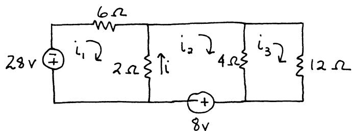
$$\text{KVL}_{\text{loop 1}} \rightarrow 28 + 6i_1 + 2(i_1 - i_2) = 0 \quad (1)$$
