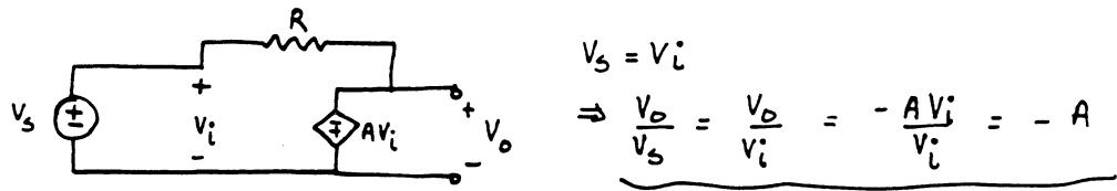
$$V_s = V_i \Rightarrow \frac{V_o}{V_s} = \frac{V_o}{V_i} = -\frac{AV_i}{V_i} = -A$$
