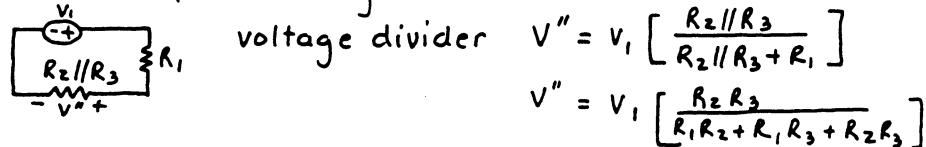
$$V'' = V_1 \left[ \frac{R_2R_3}{R_1R_2 + R_1R_3 + R_2R_3} \right]$$
