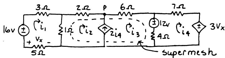
$$\text{KVL mesh } i_1, P : -16 + 3i_1 + 1(i_1 - i_2) + 5i_1 = 0 \\ \Rightarrow -9i_1 + i_2 = -16 \quad (1)$$
