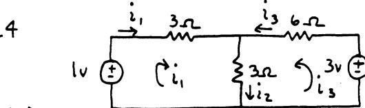
$$(a) \text{ KVL mesh } i_1: -1 + 3i_1 + 3(i_1 + i_3) = 0 \Rightarrow 6i_1 + 3i_3 = 1 \quad (1)$$
