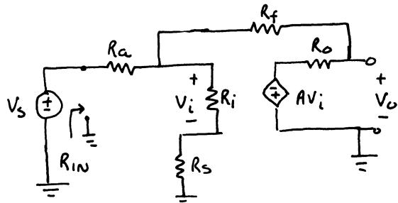
$$\text{Answers : } A_v = \frac{V_o}{V_s} = \frac{R_o(R_i + R_s) + A R_i R_f}{(R_f + R_o)(R_i + R_s) + R_a(R_f + R_o + R_i + R_s) - A R_i R_a}$$
