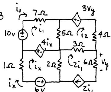
$$\text{mesh } i_1 \text{ : } -10 + 7i_1 + 5(i_1 - i_2) - 4i_x = 0 \\ \Rightarrow 12i_1 - 5i_2 - 4i_x = 10 \quad (1)$$
