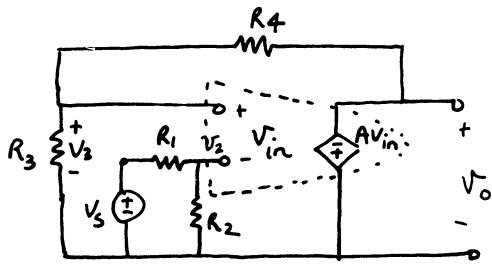
$$V_3 = \frac{R_3}{R_3 + R_4} V_o$$
