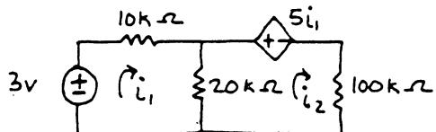
$$\text{KVL } i_1 \uparrow : -3 + 10i_1 + 20(i_1 - i_2) = 0 \Rightarrow \underline{30i_1 - 20i_2 = 3} \quad (1)$$
