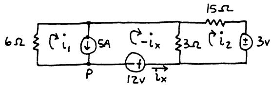
$$\text{KVL mesh } i_1 - i_x \text{ : } 6i_1 + 3(-i_x - i_2) + 12 = 0 \quad (1)$$
