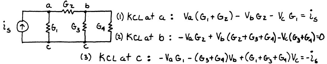
$$(1) \text{ KCL at } a: V_a(G_1 + G_2) - V_b G_2 - V_c G_1 = i_s$$
