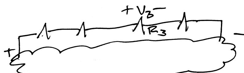
$$V_3 = V_{TOT} \cdot \frac{R_3}{\sum R_i}$$
