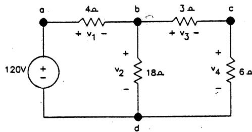
$$v_1 = 4i_s = 48 \text{ V} \quad v_3 = 3i_2 = 24 \text{ V}$$
