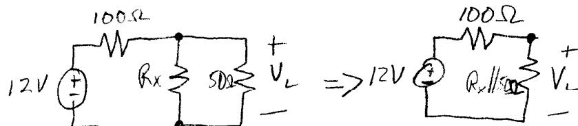
$$\Rightarrow 12V \cdot \frac{R_x \parallel 50\Omega}{100\Omega + R_x \parallel 50\Omega} V_L$$
