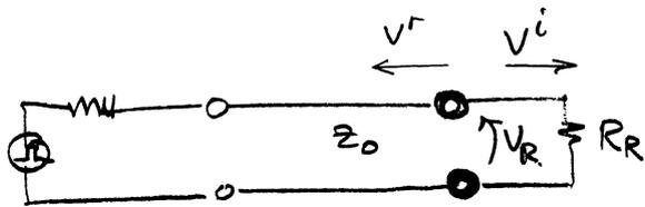
resistor.  $V_R = V_i + V_r$
